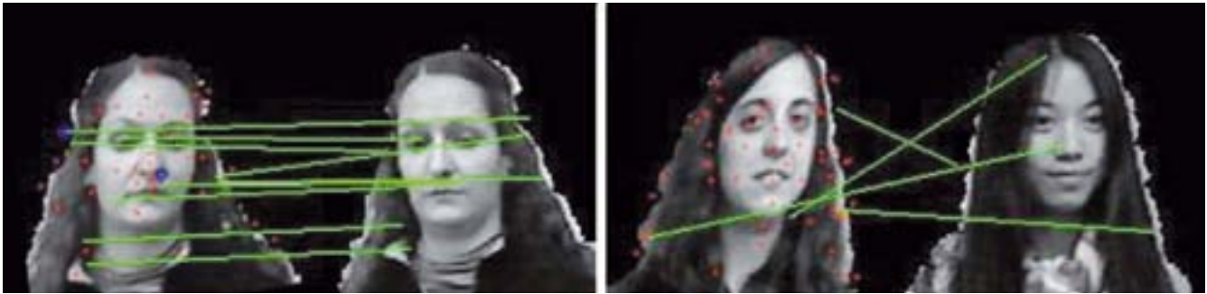
Figura 4. Procedimiento de correspondencia probabilística entre puntos faciales característicos extraídos mediante SURF. Los puntos verdes unidos con líneas ilustran una correspondencia exitosa, los rojos indican una mala de correspondencia, y los azules son outliers (no se encuentran candidatos en la imagen de la derecha). En (a) se puede ver como el resultado de la correspondencia (98.4%); mientras que en (b) se puede ver una correspondencia entre dos caras de dos sujetos diferentes (32.3%). La deformación que se aprecia en las imágenes izquierdas se debe a un preprocesado de alineación usado para mejorar la correspondencia.
