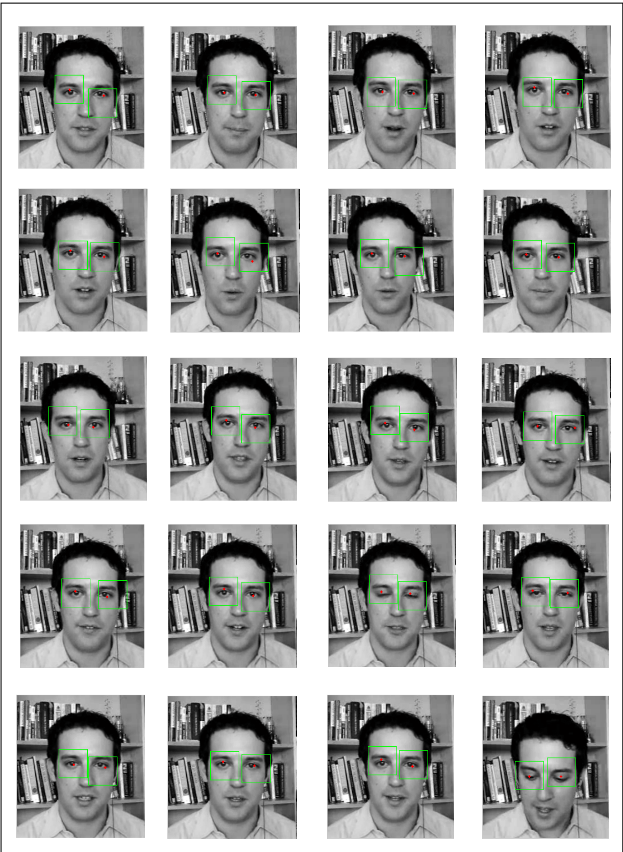
Figura 4.18: Resultados obtenidos al realizar simetría radial en una secuencia de imágenes.
