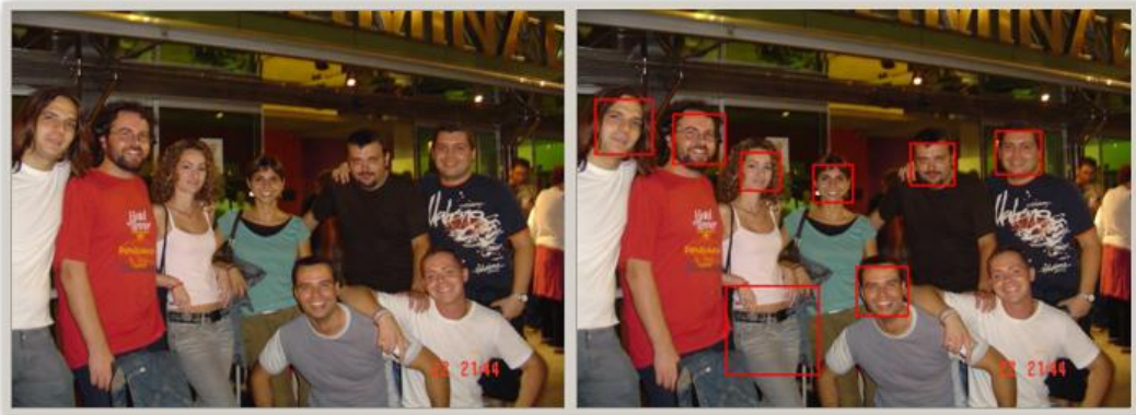
Figura 3.14: Ejemplo de la cascada de clasificación haarcascade_frontalface_alt_tree .
