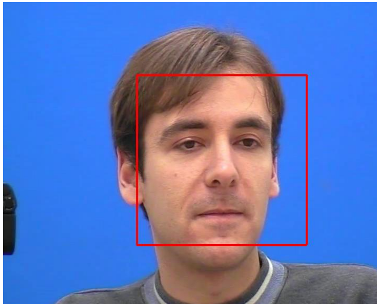
Figura 3.12: Resultado tras aplicar el detector de caras a una imagen.
