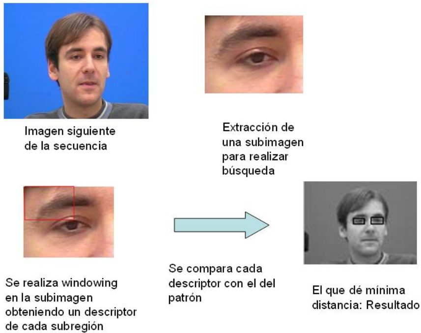
Figura 3.27: Esquema de los pasos a realizar para obtener el seguimiento de los ojos en la secuencia de imágenes.
