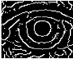
Fig 30: imagen de contornos resultante de la aplicación de Canny Edge
