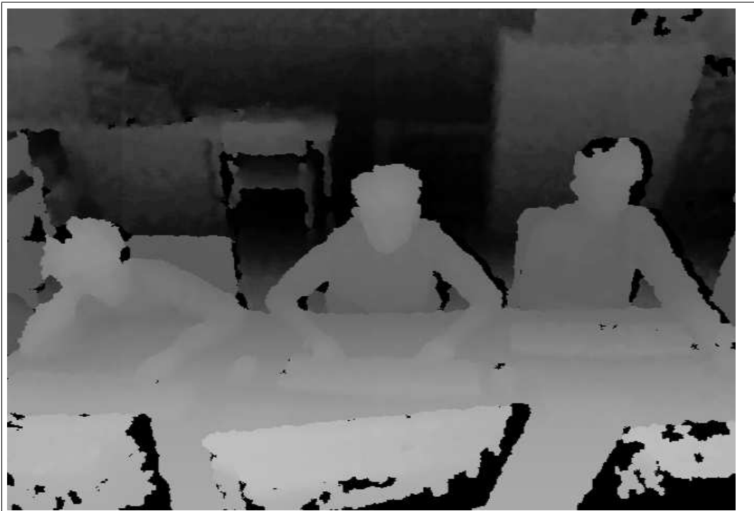
Figura 4.10: Resultado de la aplicación de la calibración automática sobre el video de la figura 4.9.
