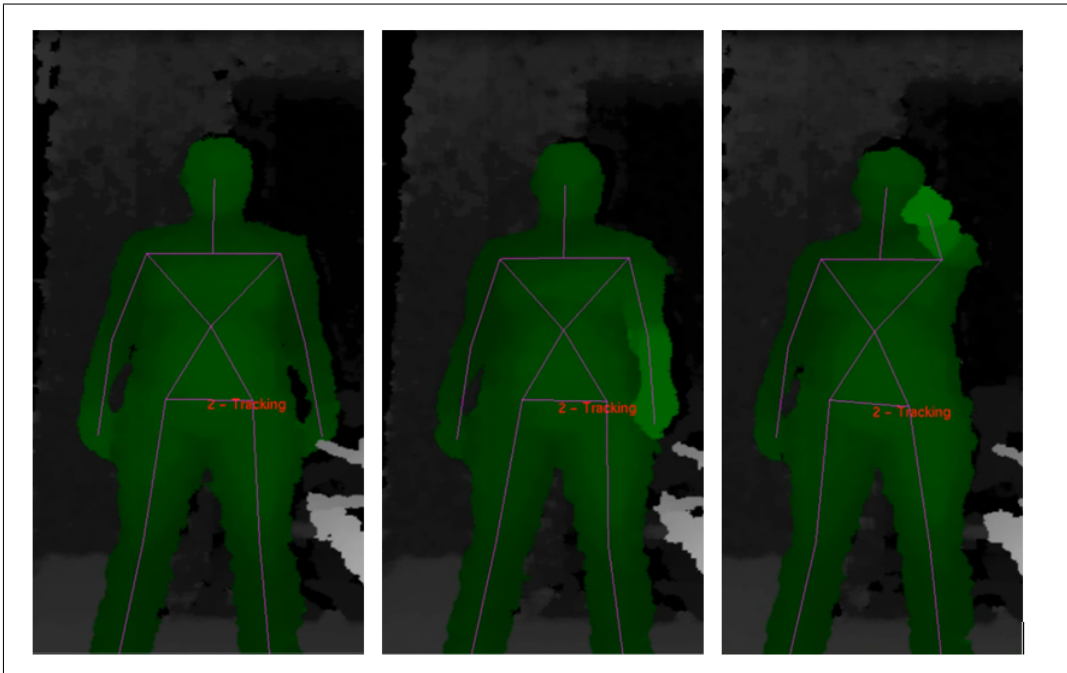
Figura 4.2: Muestra de poses para la acción de señalar al frente con la mano derecha.
